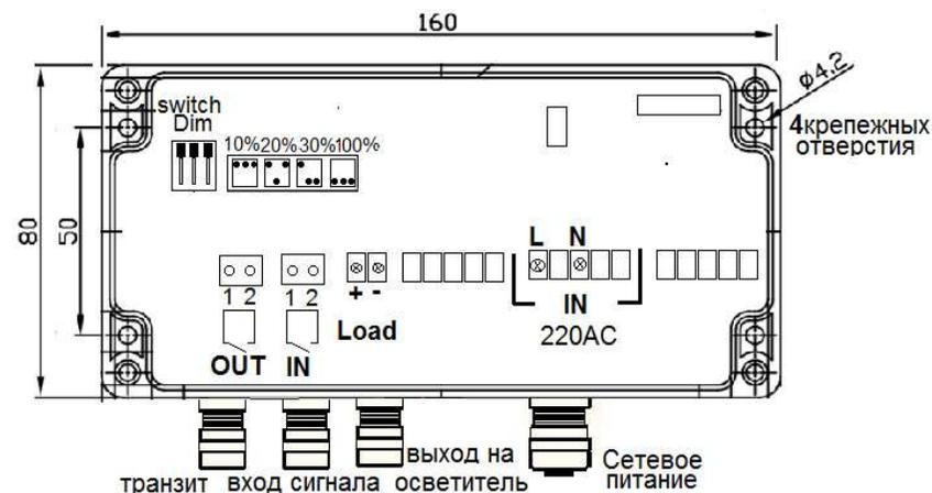
**Кабельный ввод сетевого питания- под кабель наружного Ø 10,5мм МАХ**
